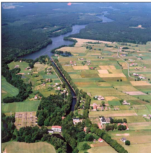
Fot. 4. Stopień wodny w Żurze – zbiornik, kanał derywacyjny i elektrownia (źródło: www.zielonaenergia.pl ) Photo 4. The Żur dam – water reservoir, derivation canal and power station (source: www.zielonaenergia.pl )
